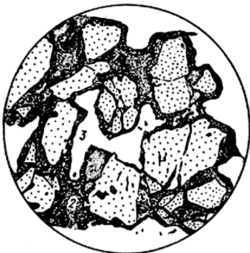
Рис. 3.2. Структура шлифовального круга под микроскопом: 1 – абразивные зерна; 2 – связка; 3 – поры
