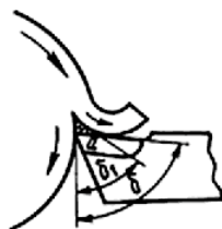
Рис. 2.2. Нарост на резце:
